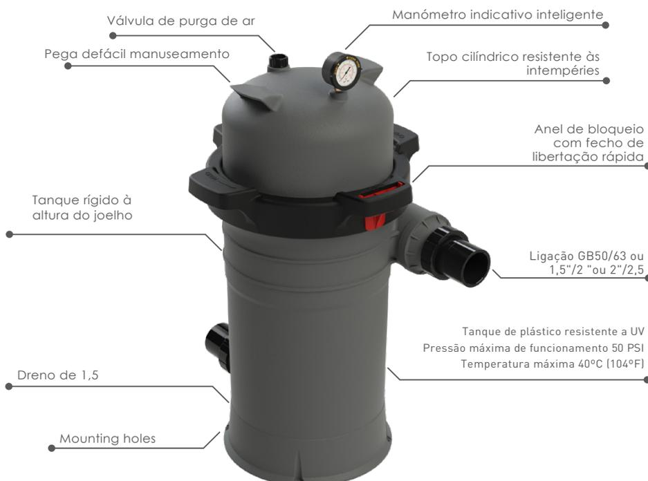
O filtro mono cartucho Galaxy é construído com material de alta resistência e resistente aos raios UV para prolongar a vida útil do produto.
